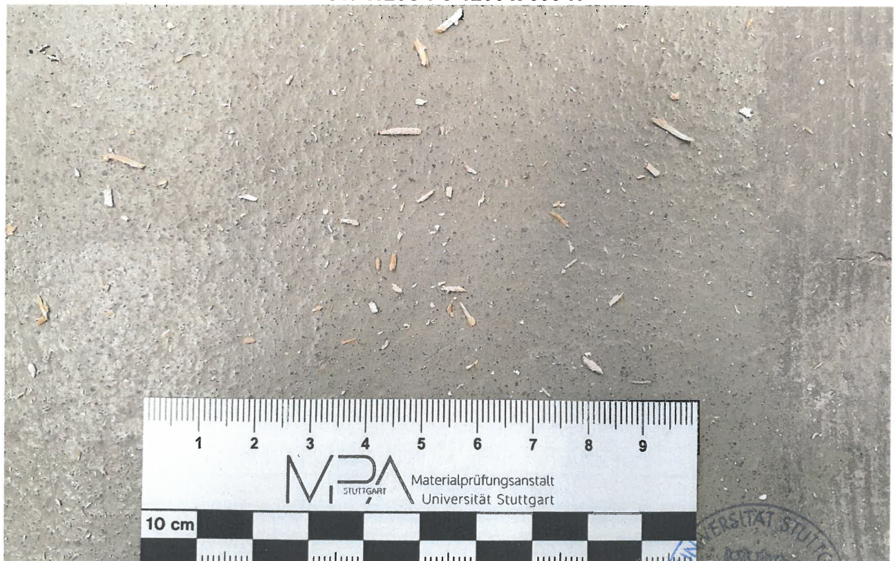
Bild 3 Abrieseln von Holzfasern "CW-W25S-P5-1200 x 600-N"
