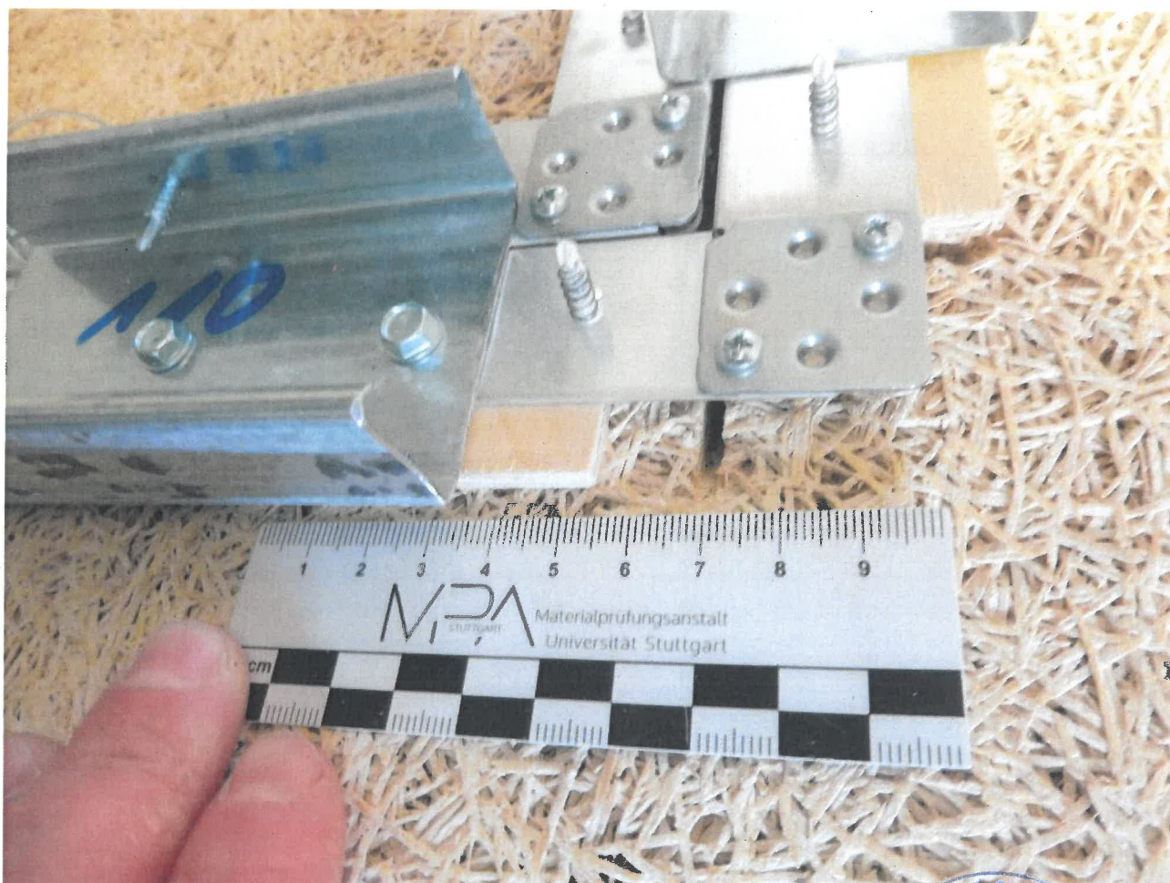
Bild 7 Detail Unterkonstruktion Revisionsklappe FD Ultra Wood
