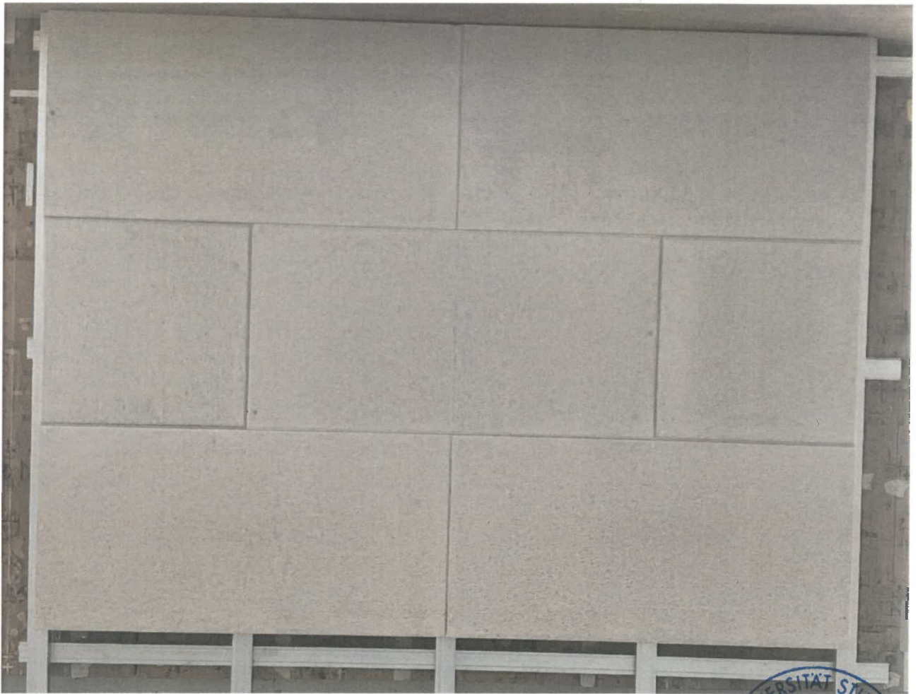
Bild 1 Gesamtansicht: Sichtseite „Deckensystem auf CD-Profilen c/c 600 mm“
