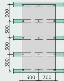
1200 x 600 mm Platten werden mit 15 Schrauben geschraubt
