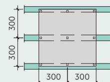
600 x 600 mm Platten werden mit 9 Schrauben geschraubt
